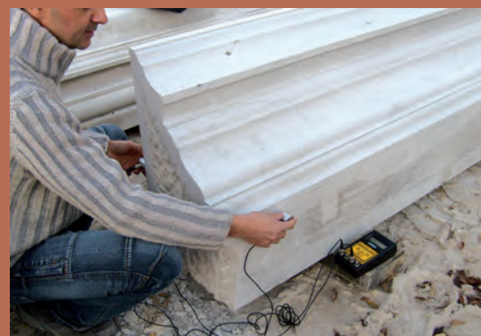
↑ Contrôle de vitesse de son pour vérifier que la pierre n'a pas de fissures à l'intérieur Sonic testing to check that the stone has no internal fissures
